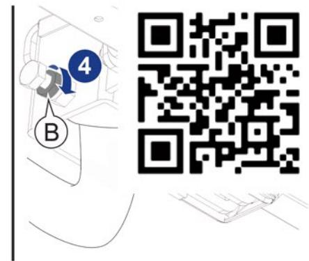
**ES** Ajuste del cabezal: Afloje la contratuerca (B), apriete el tornillo (A) hasta que el cabezal no pueda girar (en caso de que no sea posible bajar la palanca con la fuerza de la mano, afloje un poco el tornillo) tiene que ajustarse de tal manera que se necesiten alrededor de 40 kg de fuerza manual. Una vez se consiga un buen ajuste, apriete la contratuerca (B). Esta operación debe ser repetida cada vez que note que se disminuye la resistencia.
